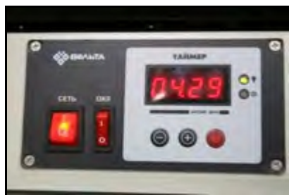
Фотолизная камера ФК-12М панель управления
