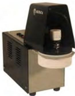
"Модуль EM-04" - электрохимический датчик для определения токсичных элементов в питьевой, природной и сточных водах, в пищевых продуктах и различных материалах.
